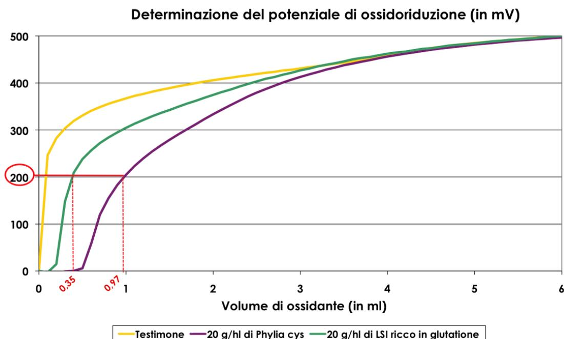
Figura: protezione di un vino bianco. Determinazione del potenziale d'ossidazione per aggiunta crescente di una soluzione ossidante (metodo Sofralab).
